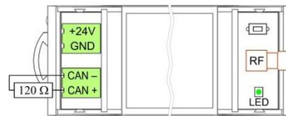
Optional: Abschlusswiderstand / terminating resistor / résistance terminale
